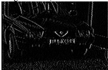
Unterabgetastetes Bild nach der Bandpaßfilterung
