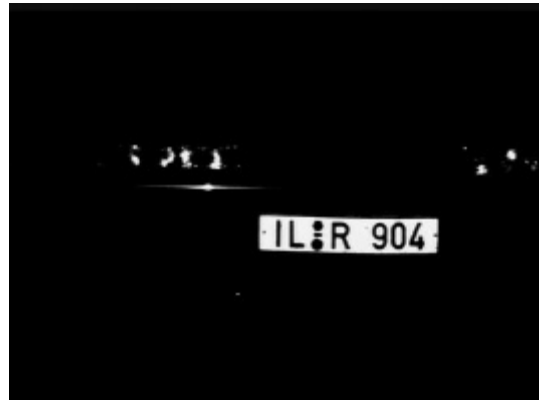
Abb. 3: Ausgangsbild für die Kennzeichenerkennung bei der Kontrolle der AGE
