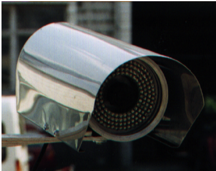
Abb. 10: Aufnahmekopf eines Systems für Zutrittskontrollen
