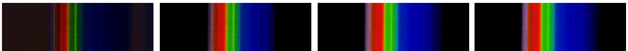
Abb. 10: Aufnahme des Spektrums einer HQI-Lampe mit einem Spektrometervorsatz an einer SMK98-Kamera (Darstellung linear, Log 2 Dekaden, Log 3 Dekaden und Log 4 Dekaden)
