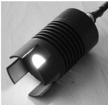
Abb. 4: L^3 -Normal (Lichtstrom, Leuchtdichte, Lichtstärke) mit Lichtstärkegradienten
