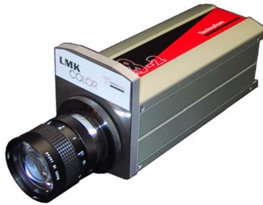
Bild 2: LMK98 Color (CCD-Kamera mit Filtrerrad (6 Öffnungen) zwischen Objektiv und CCD-Matrix)
