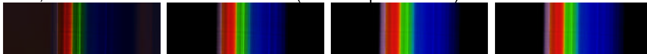
Bild 18: Aufnahme des Spektrums einer HQI-Lampe mit einem Spektrometervorsatz an einer SMK98-Kamera (Darstellung linear, Log 2 Dekaden, Log 3 Dekaden und Log 4 Dekaden)
